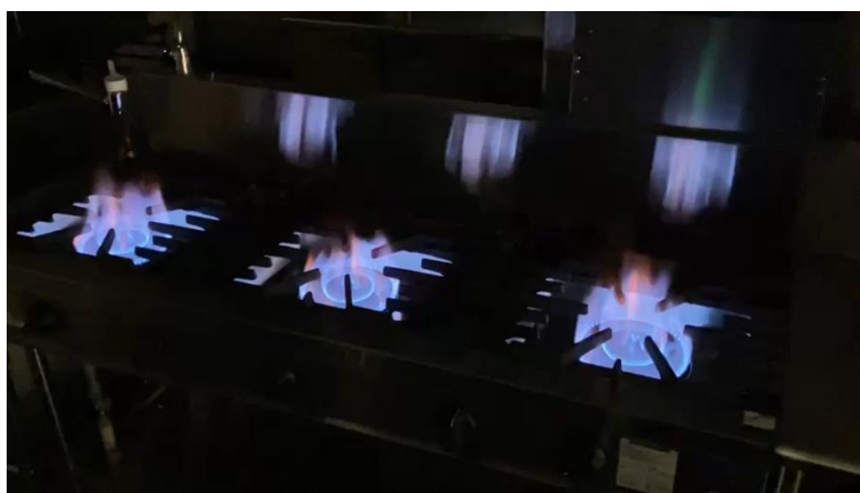
図10 迎賓館厨房での e-メタン燃焼試験写真
