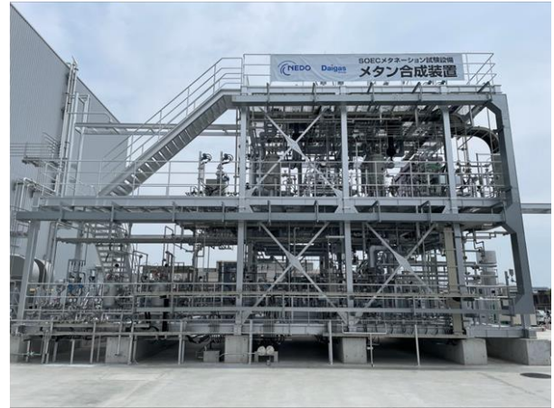
図7 SOEC メタネーションのベンチスケール試験装置
