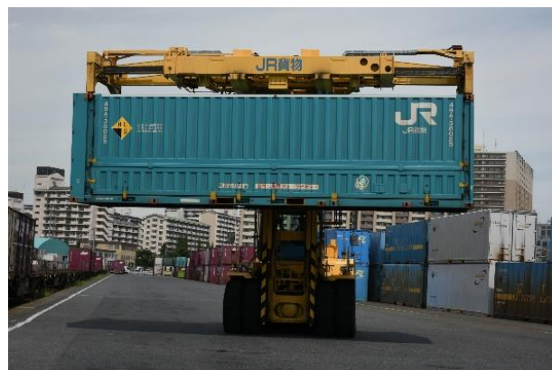
図5 31フィートコンテナと荷役機
