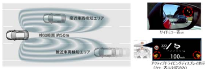
図 3.3.4-4 見え難い位置の車両を検出してアラームを出し、注意を促すシステムの事例 25
