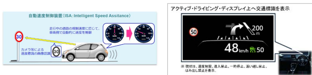
図 3.3.4-3 標識認識機能による見落とし防止支援の事例 23 24
