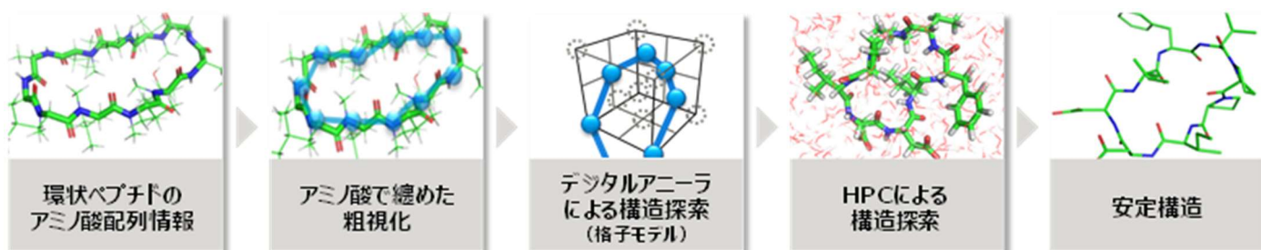
図 2: 「デジタルアニーラ」による中分子環状ペプチドの安定構造探索の流れ
